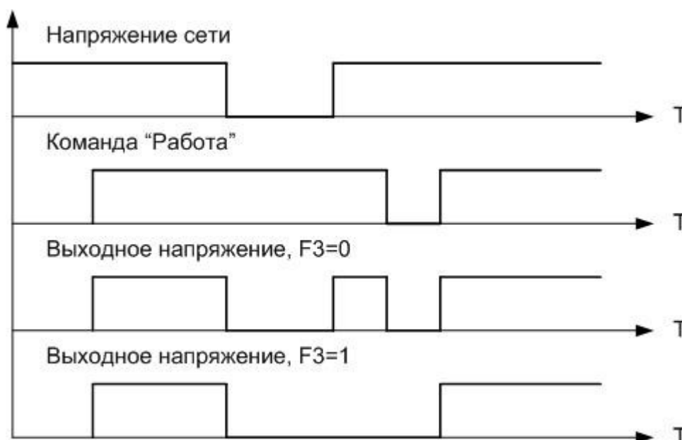
Рисунок 3.2 Применение функции F3
