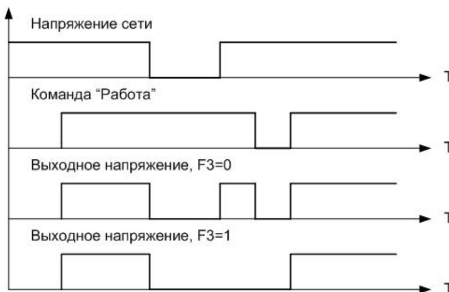
Рисунок 3.2 Применение функции F3
